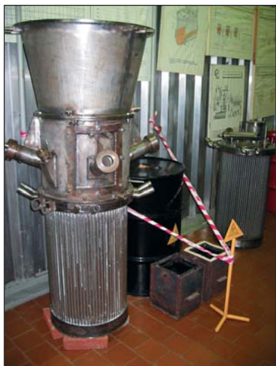
Рис.7. Индукционный плавитель «холодный тигель» для остекловывания ядерных отходов.
