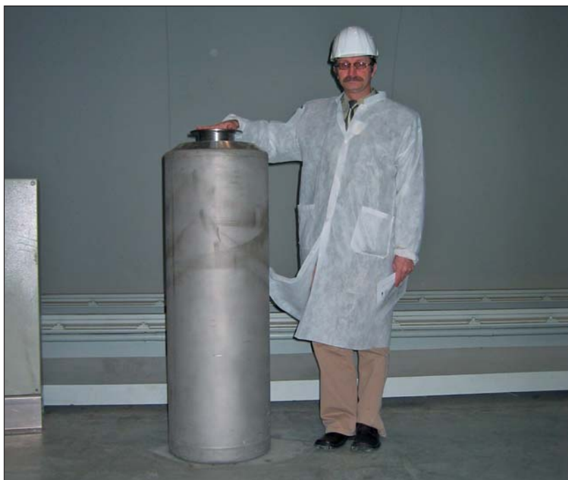
Рис.8. Канистра с имитатором высокоактивных отходов. Для остеклованных высокоактивных отходов мощность радиации настолько высока, что человеку невозможно подойти к канистре раньше, чем наступит смерть от переоблучения.
